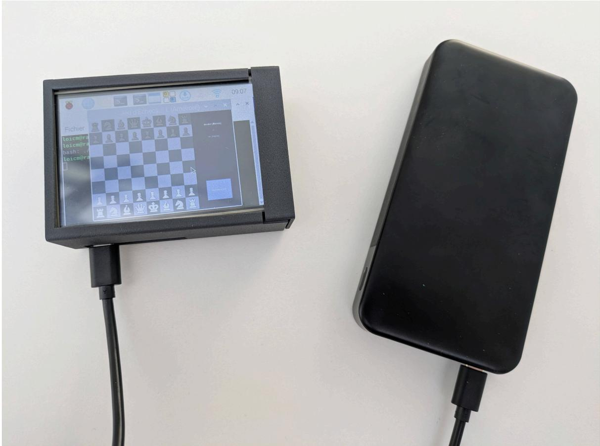
La console a été réalisée avec un raspberry pi 5.
